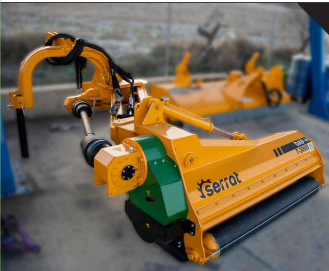
Desbrozadora de alta gama con rotor agrícola, multiuso polivalente, lateral y posterior, para trabajos en márgenes agrícolas, taludes, autovías, canales, carreteras y demás desbroce de obras públicas para tractores de 120 - 180 CV.
