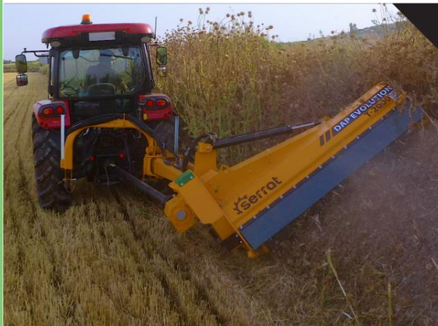
Desbrozadora de alta gama, multiuso polivalente, lateral y posterior, para trabajos en márgenes agrícolas, taludes, autovías, canales, carreteras y demás desbroce de obras públicas para tractores de 70 - 120 CV. Válvula de seguridad contra accidentes. Angulación +90° / -50°. Dos posiciones en portón trasero. Rotor POLSER de 450 mm de diámetro con martillos de alto filo.
