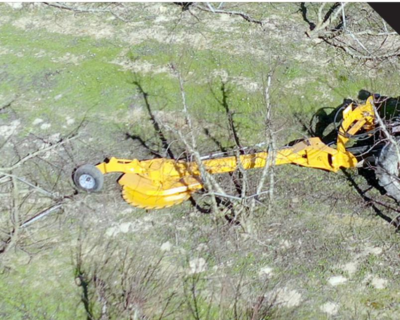
Disco-satélite de eje vertical y accionamiento mecánico para cortar troncos de árboles frutales de 150-200 mm de diámetro.
