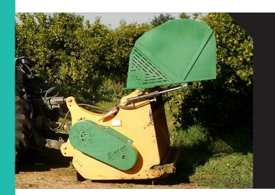
Trituradora apta para el corte y recogida de hierba y ramas hasta 80 mm de diámetro.
