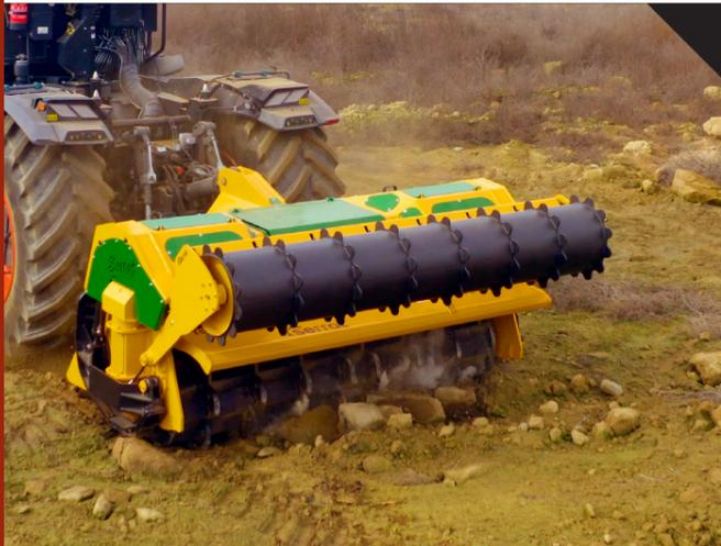
Máquina de preparación de suelo hasta una profundidad de 500 mm, para tractores con Creeper o Vario entre 400 y 700 CV.
