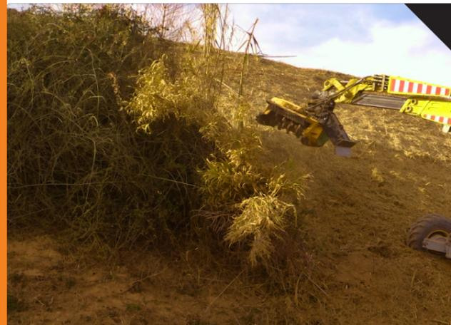
Cabezal adaptable a brazos forestales y excavadoras entre 6 - 15 TM. Chasis en chapa antidesgaste de 8 mm con el enganche atornillado en la parte superior, sobre largueros, que refuerzan el chasis, dando la posibilidad de varias posiciones de uso. Apta para desbroces forestales, cañas, matorrales, hasta Ø 80 mm.
