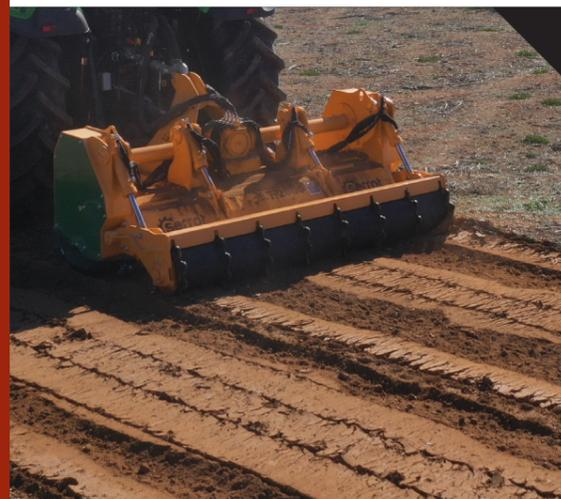
Máquina de preparación de suelo hasta una profundidad de 250 mm, para tractores con Creeper o Vario entre 80 - 130 CV.
