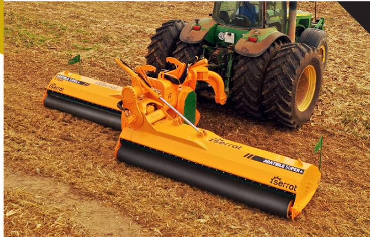
La Abatible Super + es una composición de dos máquinas estándar, superpuestas en el trabajo, unidas por un cuerpo central con sistema de auto plegado. La composición puede llegar a 7,30 m. El diseño de su transmisión por el interior deja los laterales limpios de obstáculos para la aproximación a las coberturas, etc. Su uso va dirigido al triturado de pastos y agricultura en general (maíz, sorgo, algodón) o la siega de hierba en pastizales, aeropuertos, etc.
