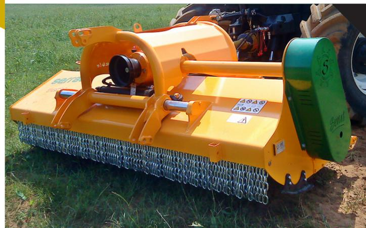
Se utiliza para triturar ramas de poda, restos de cultivo de verano, pastizales, parques y jardines. Es una trituradora de uso Universal y de altísima fiabilidad. Rotor POLSER de 550 mm de diámetro para madera hasta 100-120 mm de diámetro. Su configuración reversible y desplazable permite proteger al tractor al no tener que pisar el material a triturar y ajustar el campo de trabajo lateralmente mediante cilindro hidráulico.
