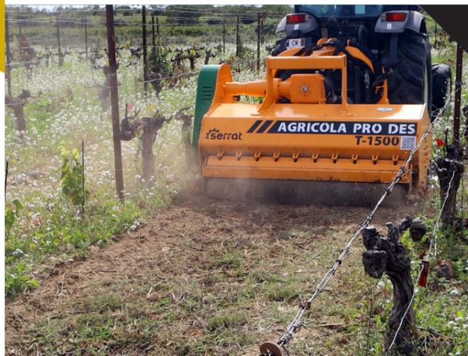
Se utiliza para triturar ramas de poda, restos de cultivo de verano, pastizales, parques y jardines. Es una trituradora de uso Universal y de altísima fiabilidad. Rotor POLSER de 550 mm de diámetro para madera hasta 100-120 mm de diámetro. Su composición desplazable (paralelogramo) permite al tractor circular por el centro de la calle y a la máquina operar más cerca del árbol.
