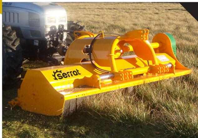
Trituradora de martillos, para la eliminación de restos de poda de hasta 80 mm y mantenimiento del manto vegetal. Ideal para la regeneración de praderas y pastizales. Rotor POLSER de 450-500 mm de diámetro. Excelentes resultados en jardinería industrial y mantenimiento de arcenes. Su configuración reversible y desplazable permite accionar la máquina bien en la parte posterior como en el tripuntal delantero y en tractores reversibles para no pisar el material a triturar.
